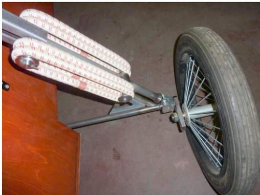
Après des essais de charges, nous avons défini le nombre d'élastiques à placer pour un bon amortissement. Le DL chargé à 650kg, un essai de chute a été réalisé à partir d'une rampe.
