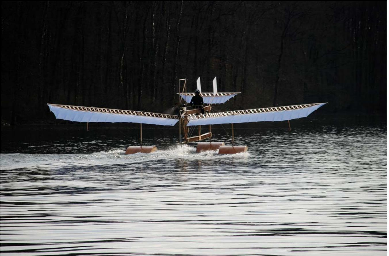
Hydroplanage à vitesse maximale. Le tirant d'eau résiduel des flotteurs empêche néanmoins l'appareil d'atteindre la vitesse de décollage :
