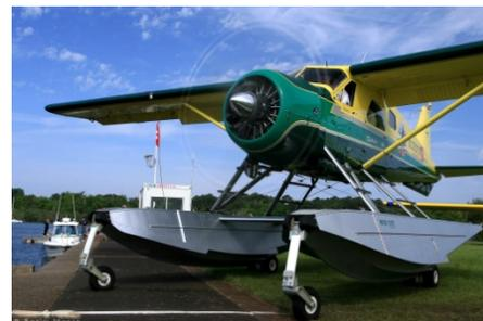
Pour ces deux options, anticiper l'utilisation de cales de mises à l'eau (plans inclinés). Attention à l'envergure nécessaire pour un hydroaéronef (présence de murets et de poteaux, etc.) Là encore, l'aile haute d'un hydro à flotteurs peut passer un muret ou des piquets.
