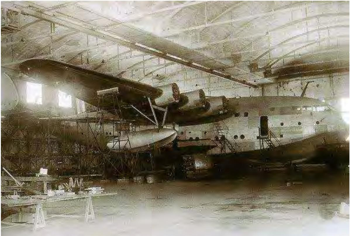
*Le SE 200 en construction dans le hangar Boussiron de Marignane (1941).*
